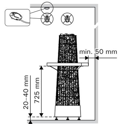
**HUOM!** Kaiteen asennusetäisyys alittaa kiukaan asennusohjeessa mainitut suojaetäisyydet. Kaiteen ja kiukaan yhdistelmä on kuitenkin testattu huolellisesti ja etäisyys on todettu riittäväksi. Lue myös kiukaan asennusohje.
