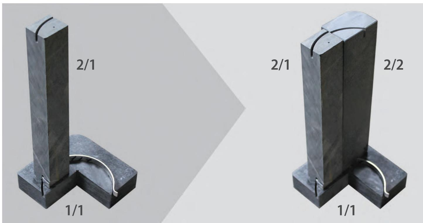
По мере установки деталей закрепляем их скобами.
